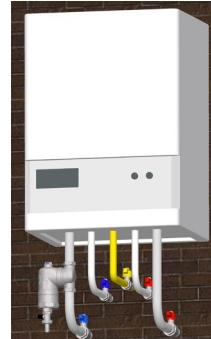
На рисунке изображен грязеуловитель установленный на вертикальном участке трубы. Такой способ подключения рекомендуется когда вы располагаете пространством по вертикали под котлом.
