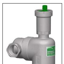
Nella parte superiore del defangatore è presente un attacco filettato con un tappo dove è possibile installare una valvola automatica di sfogo aria per facilitare l'espulsione dei gas. Per l'eventuale installazione della valvola di sfogo aria automatica FAR, rimuovere il tappo superiore e avvitare la valvola. L'attacco superiore è da 1/2" per tutti i modelli di defangatore.
