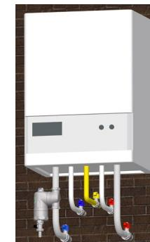
In figura è rappresentata l'installazione di un defangatore sulla tubazione di ritorno con il raccordo orientabile in posizione verticale.
