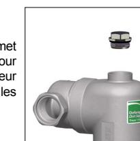
Le haut du pot à boue présente un raccord fileté avec bouchon, qui permet d'installer un purgeur automatique pour faciliter l'expulsion des gaz. Pour l'installation du purgeur d'air automatique FAR, retirez le capuchon supérieur et vissez le purgeur. Le raccord supérieur de 1/2" est le même pour tous les modèles de pots à boues.
