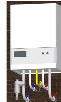
La figure montre l'installation d'un pot à boue sur le tuyau de retour avec le raccord orientable en vertical. Cette configuration est recommandée si vous avez assez d'espace à la verticale sous la chaudière.
