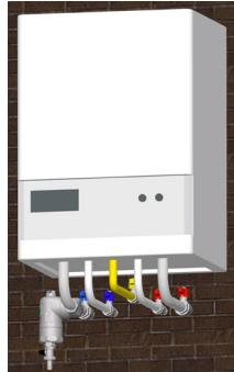
На рисунке изображен грязеуловитель установленный на горизонтальном участке трубы. Благодаря поворотному соединению, после установки, грязеуловитель принимает вертикальное положение. Такой способ подключения рекомендуется когда вы располагаете пространством по глубине большим чем по вертикали под котлом.
